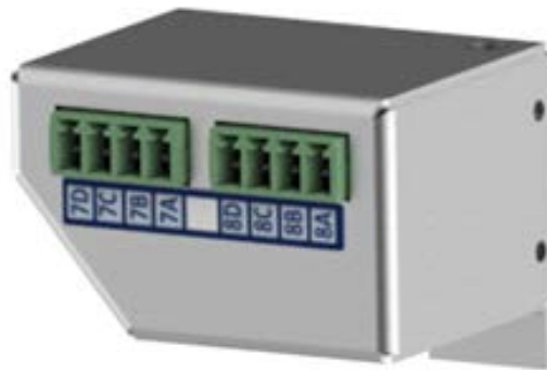
Fig. 23 Cableado módulo CAN / CAN module wiring.
